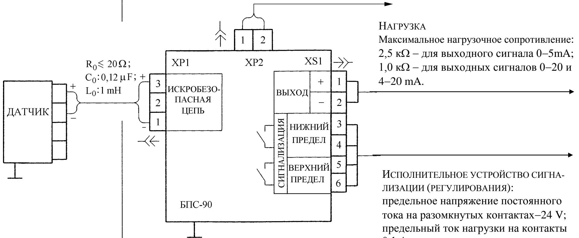
ИСПОЛНИТЕЛЬНОЕ УСТРОЙСТВО СИГНАЛИЗАЦИИ (РЕГУЛИРОВАНИЯ):
